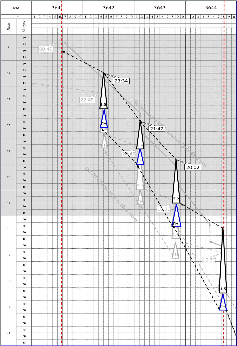
Рис. 3. Фрагмент часового графика производства по объекту капитального ремонта 1 уровня – капитальный ремонт железнодорожного пути с использованием новых материалов, участок Ижморская – Б.П. 3655км (Берикульская) I путь – ПРСМ
