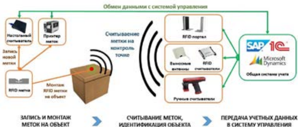
Рис. 2. Схема принципа работы технологии RFID [17]
